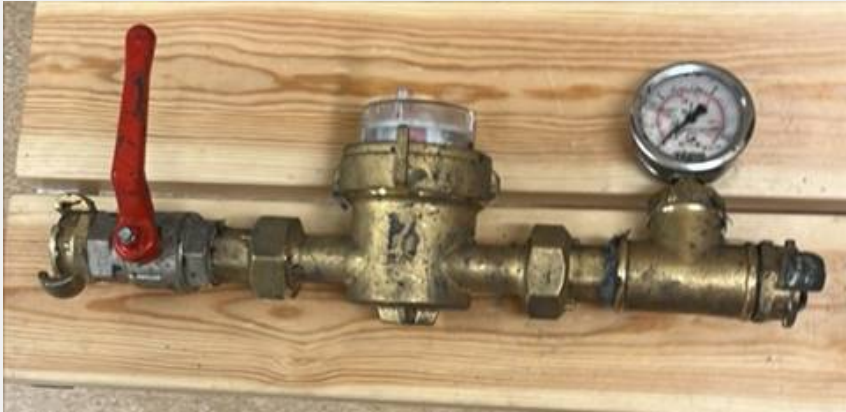
Utstyr for forenklet vanntapsmåling i injeksjonshull
